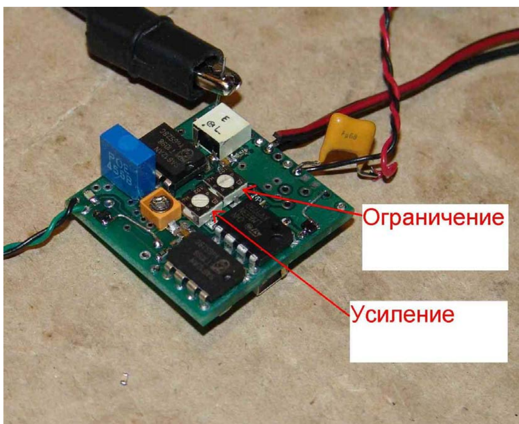
Рис. 4 Регулировка уровней ограничения и усиления ВЧ ограничителя
